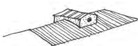
Verrière à deux pentes en pignon
